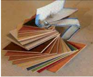
فیبرها الیاف باریک و کشیده چوبی و غیرچوبی هستند که آن‌ها را ابتدا خردکرده و تحت حرارت 300 درجه سانتی‌گراد بخار می‌دهند تا الیاف آن‌ها جداسده و با مخلوط رزین و موکب به هم فشرده می‌کنند و در ضخامت، فرم‌ها، نقش‌ها و ابعاد مختلف 220\*180\*183 و 250\*120\*183 و 360\*160 سانتی‌متر به بازار عرضه می‌نمایند.
