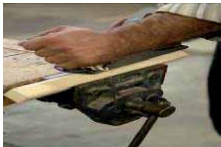
دستهای که جعبه ابزار را که مقطعی مربع دارد و اندازه آن  $3*3$  سانتی‌متر هست بایستی گرد شود. برای این منظور چوب به ابعاد  $30*3$  سانتی‌متر را به صورت ذوزنقه بگیریم میز کار بسته و به‌وسیله رنده فلزی یا چوبی تیزی گوشه‌های هر چهار طرف را با رندیدن از بین ببرید.
