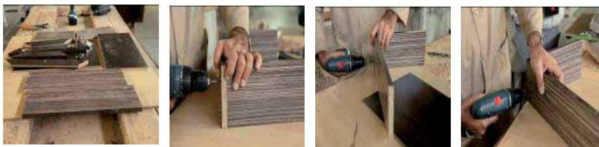
پس از اتصال بدنه‌ها به هم پشت‌بند آن را که از MDF به ضخامت 8mm بریده‌اید به‌صورت لب به لب از کف تا سقف قرار داده و آن را به بدنه‌ها پیچ کنید.
