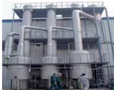
شکل: نمونه هایی از تبخیر کننده های صنعتی
