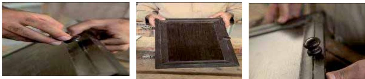
حالا باید در را بر روی بدنه نصب نمود. برای این منظور باید از لولا گازر استفاده شود. ابتدا باید محل لولا در زهوار در ایجاد شود. به وسیله دریل دستی برقی محل لولا را مشخص و با متنه مخصوص گازر آن را به عمق مناسب سوراخ کنید.
